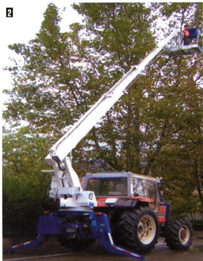
Foto 2. Plataforma con el brazo elevador enganchado directamente al tractor.
