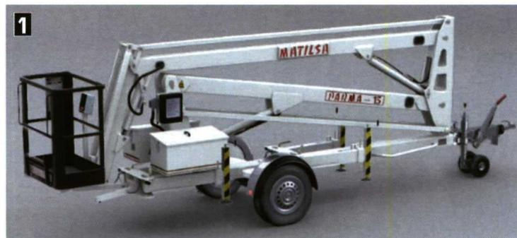
Foto 1. Plataforma elevadora para ser remolcada por otro vehículo.
