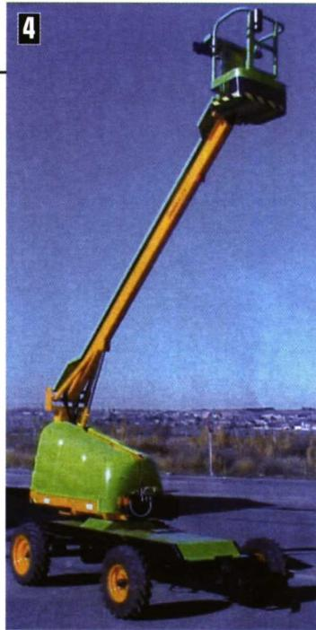
un espacio amplio sin tener que cambiar de lugar el vehículo. En la base del vehículo está el compresor accionado por el motor diésel y un depósito de aire comprimido que puede tener una capacidad de 40 litros donde el aire se almacena a una presión de hasta 10 bares.
