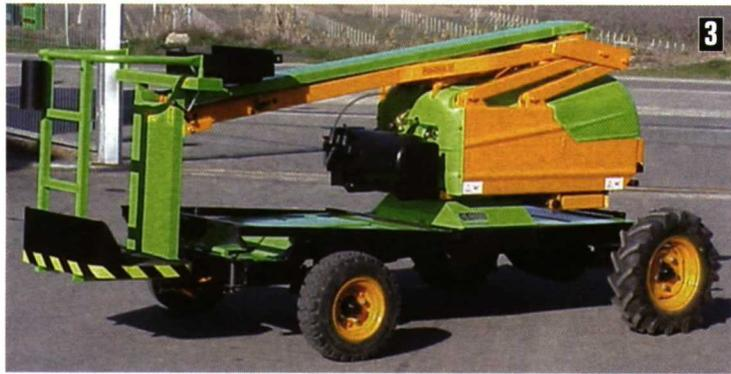
Foto 3. Plataforma elevadora autopropulsada con dos ruedas motrices y el brazo recogido.
