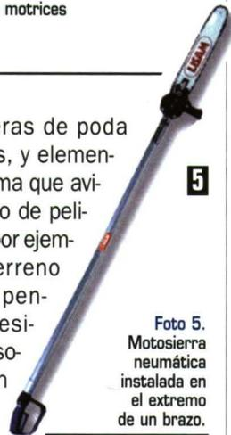
Foto 5. Motosierra neumática instalada en el extremo de un brazo.
