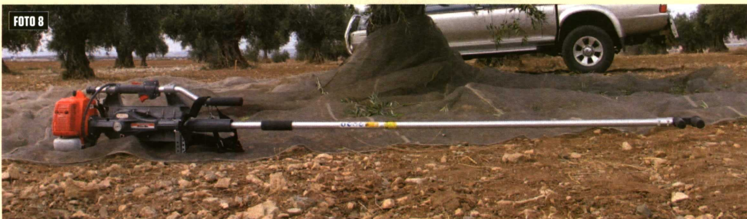
Foto 8. La máquina descansando sobre los soportes de apoyo mientras el tubo y el gancho no se apoyan en el suelo.
