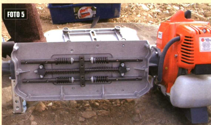
Foto 3. El peso total es de 14 kg, que el operario soporta de una correa que se pasa sobre su hombro. Foto 4. Colector que puede colocarse en la entrada de aire (debajo de la carcasa de color naranja) para forzarlo a entrar rozando con la cámara donde se encuentra el motor. Foto 5. Conjunto de muelles y varillas que amortiguan la vibración de modo que no alcance al operario.
