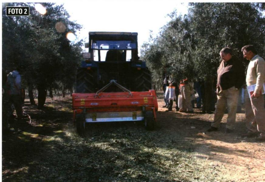
Triturado de restos de poda con una trituradora mientras avanza sobre el terreno enganchada a un tractor.
