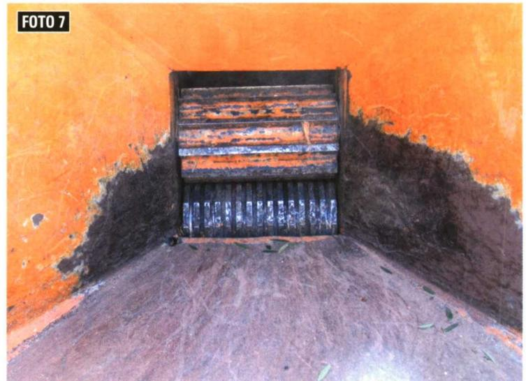
Detalle del mecanismo que agarra e introduce las ramas al fondo de la boca de alimentación.
