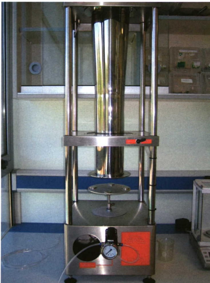
Foto 2 (izquierda). Torre de Potter utilizada para la aplicación de tratamientos.
