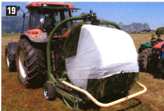
19. Encintadora Elho RF 1400 en el momento de sujetar el cabo de la lámina de plástico para después envolverla.
