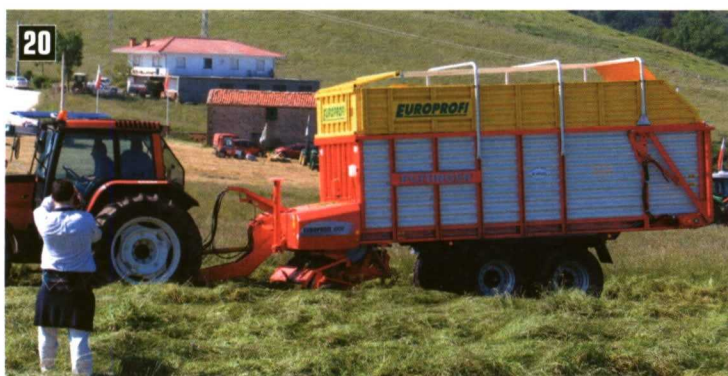
20. Remolque autocargador Pöttinger Europrofi 4500.
