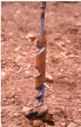
Para la correcta toma de muestras de suelo es necesario utilizar una broca o barrena sacamuestras específica.
