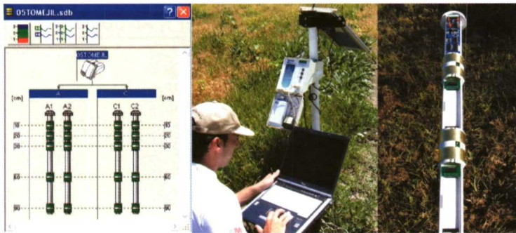
Foto 2. Disposición de los sensores en la sonda Enviroscan, regleta portasensores y descarga de datos a través del registrador conectado a una placa solar.
