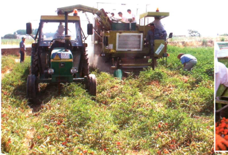
Foto 5 (superior izquierda y derecha). Cosechadora de tomate de industria modificada para recoger tomate cherry.
