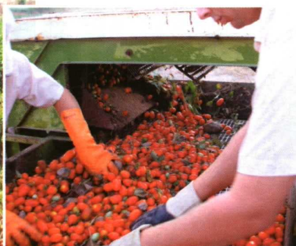
Foto 5 (superior izquierda y derecha). Cosechadora de tomate de industria modificada para recoger tomate cherry.
