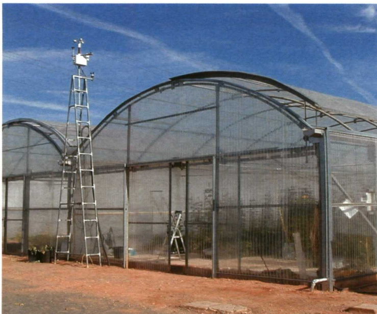
El invernadero utilizado para los ensayos es de policarbonato equipado con ventilación cenital, nebulización de alta presión, calefacción por aerotermos y radicular, y un conjunto de sensores.
