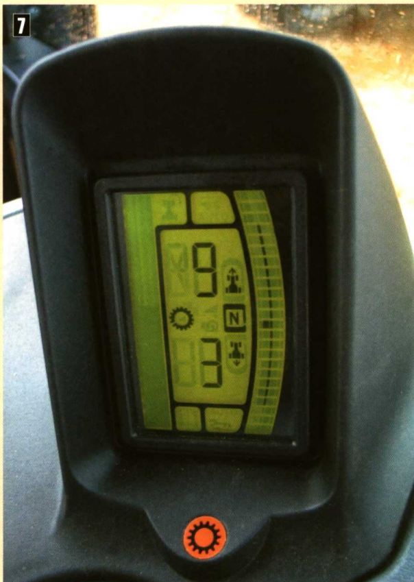
Foto 7. Pantalla que, entre otras funciones, informa de la marcha en que se avanza hacia adelante y a la que se avanzaría si se invirtiese el sentido.
