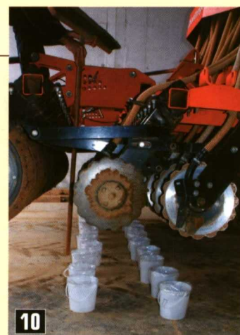
10 Ubicación de los cubos para la recogida de semilla en el ensayo estático.
