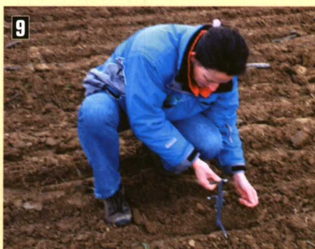
Medidas de profundidad realizadas con un pie de rey.
