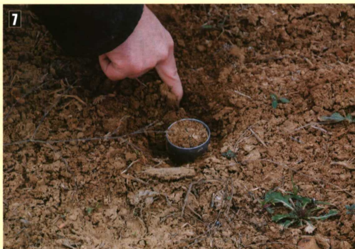
7 Procedimiento de muestreo para la determinación de la densidad aparente.
