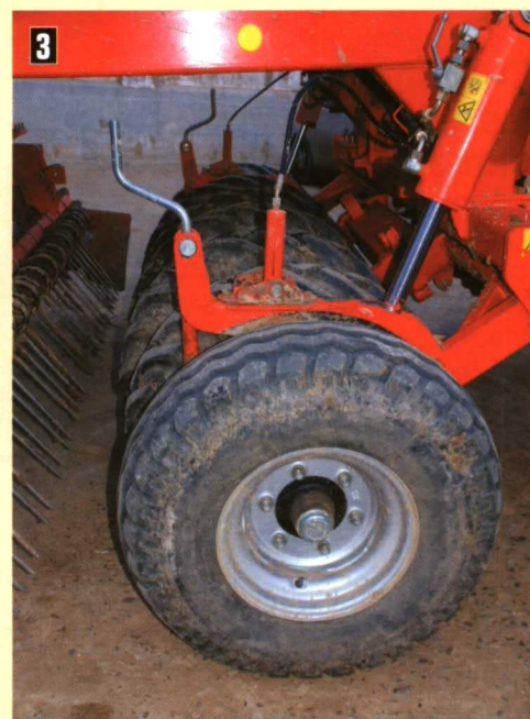
Diferencia en la línea de ruedas de compactación.
