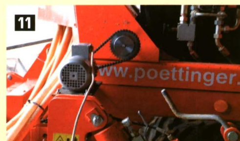
11 Detalle del motor eléctrico empleado para el accionamiento constante del eje del distribuidor en los ensayos estáticos.
