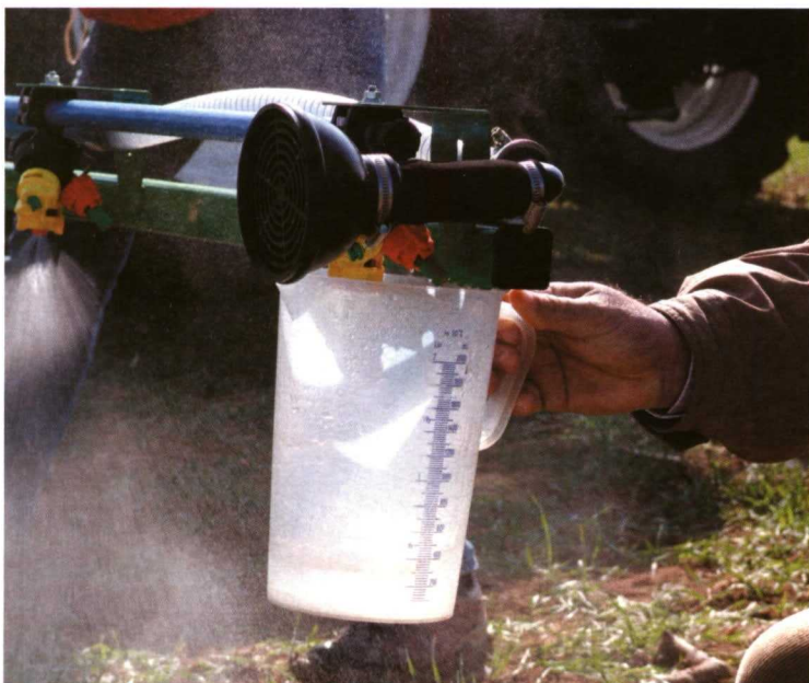
Foto 4 (arriba). Determinación de la uniformidad de distribución de la pulverización en el laboratorio del Centre de Mecanització Agrària.
