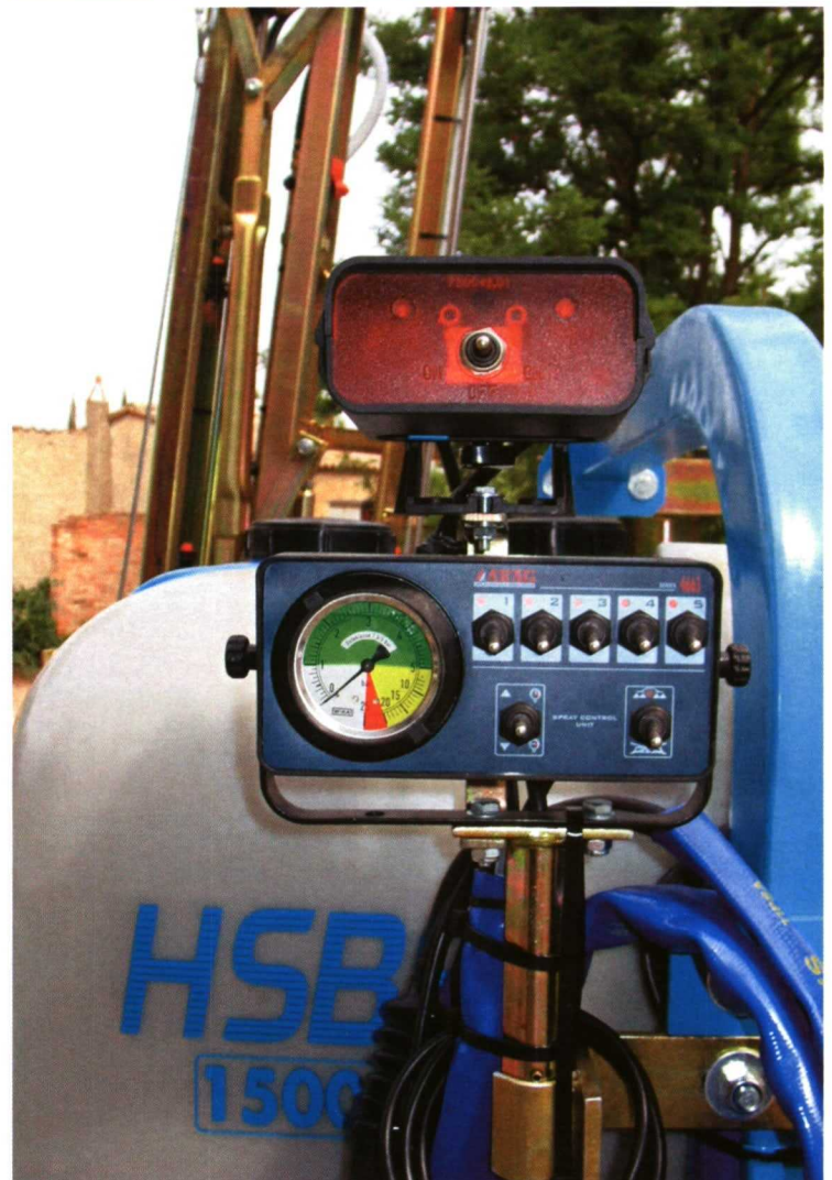
Foto 2 (arriba). Agitación hidráulica del depósito de un pulverizador. Foto 3 (abajo). Sistema electrónico de regulación de un pulverizador.
