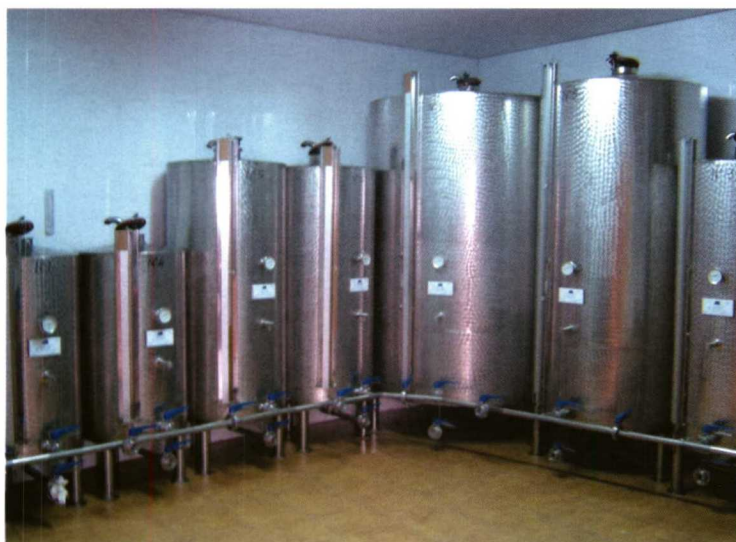
Depósitos para el almacenamiento de aceite.
