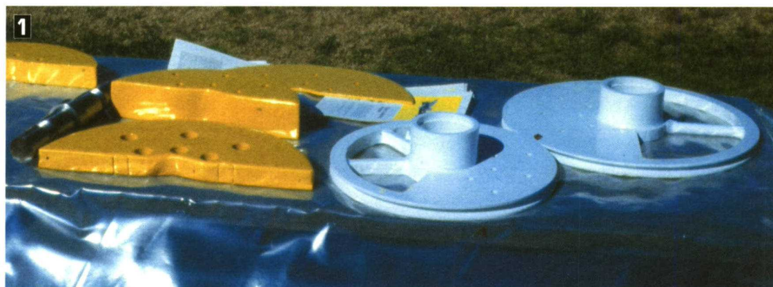
1. Juegos de poleas y masas excéntricas de recambio para un vibrador. 2. Cadena floja de la que cuelga el vibrador por haberse bajado el bastidor después de que la pinza haya apretado el tronco.
