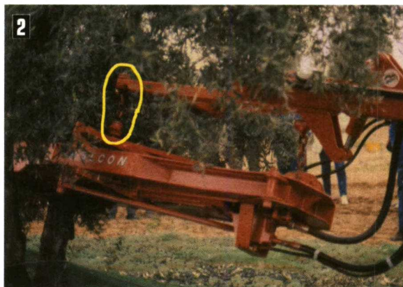
1. Juegos de poleas y masas excéntricas de recambio para un vibrador. 2. Cadena floja de la que cuelga el vibrador por haberse bajado el bastidor después de que la pinza haya apretado el tronco.
