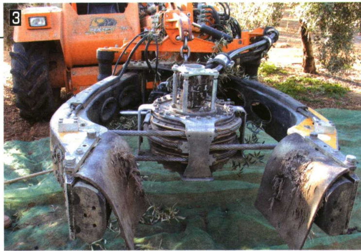
3. Desgaste de las lonas que cubren los tacos de caucho de la pinza.
