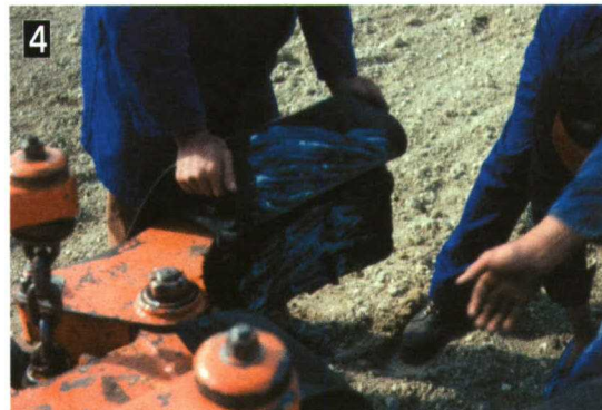
3. Desgaste de las lonas que cubren los tacos de caucho de la pinza.
