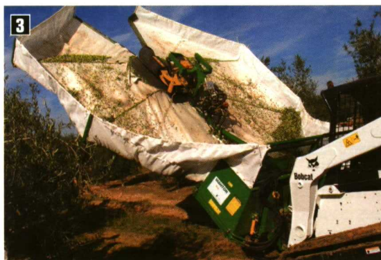
Foto 1. Vibrador y mantor con las lonas replegadas montados sobre el mismo vehículo. Foto 2. Vibración de un olivo pequeño de verdeo ayudado con peines oscilantes eléctricos. Foto 3. Mantor inclinado para que las aceitunas resbalen hacia su tolva. Foto 4. Descarga de la tolva de mantor sobre una mantilla.
