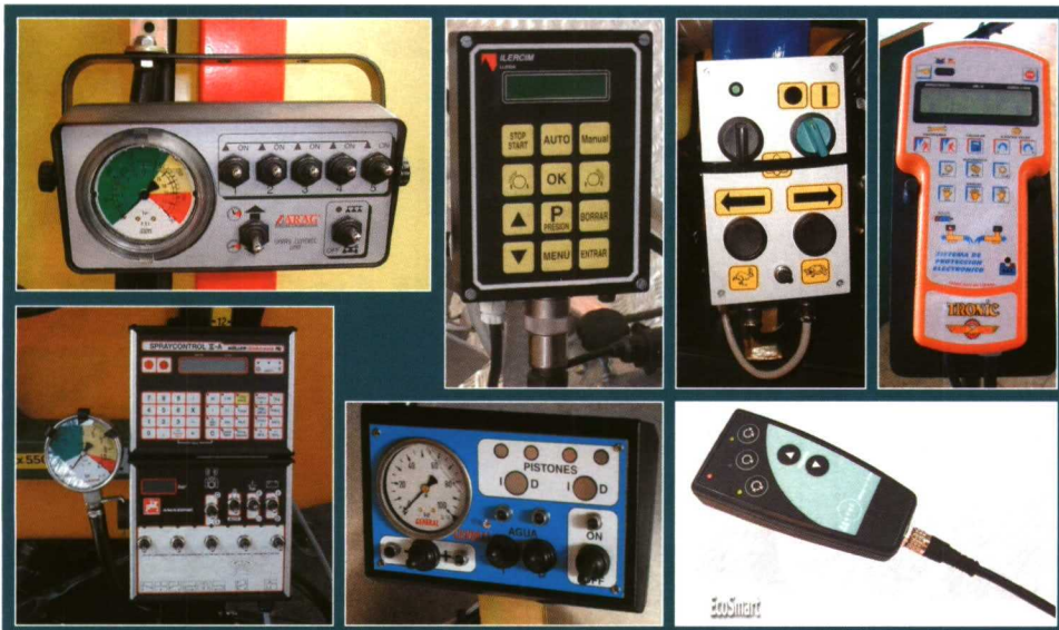
Foto 4. Los componentes electrónicos permiten una regulación automática del equipo. Existen diversos sistemas en el mercado.
