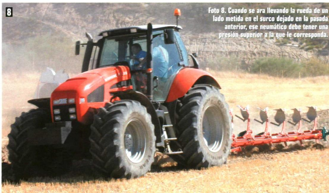
**Foto 8.** Cuando se ara llevando la rueda de un lado metida en el surco dejado en la pasada anterior, ese neumático debe tener una presión superior a la que le corresponda.
