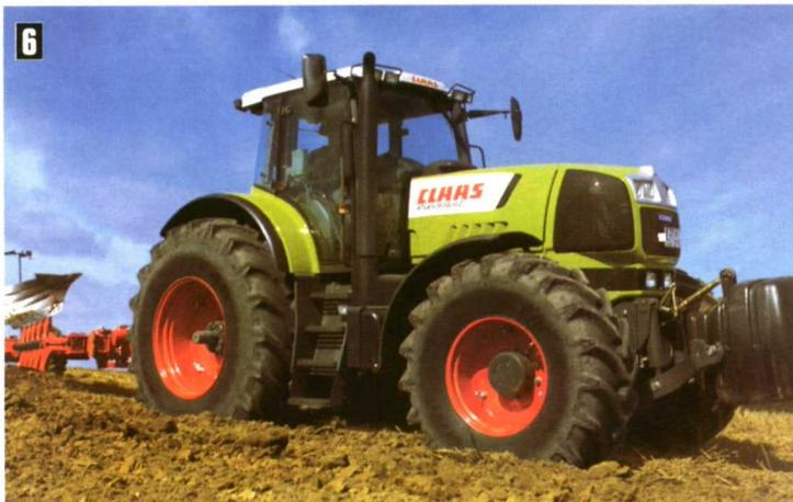
Foto 5 y 6. Ejemplo de lastrado en un tractor con brazos de enganche delantero. Foto 7. Situación de variación continua del ancho de vía.
