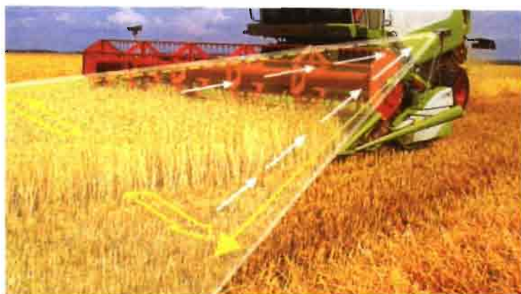
Derecha, abajo. El control de la velocidad en función de la carga de la trilla lo consiguen las nuevas John Deere mediante el sistema HarvestSmart.
