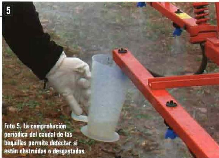
**Foto 5.** La comprobación periódica del caudal de las boquillas permite detectar si están obstruidas o desgastadas.
