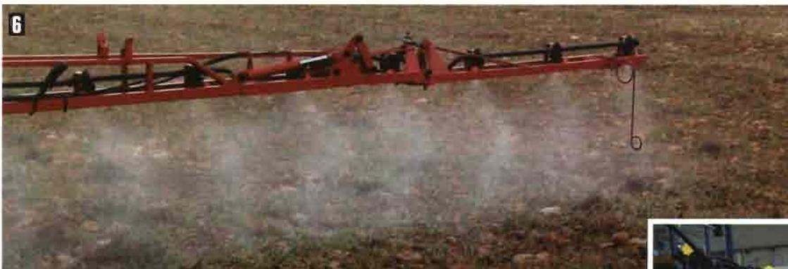
**Foto 6.** Una buena regulación de la altura de barra sobre el cultivo o suelo y su paralelismo respecto al mismo, son imprescindibles para lograr una buena distribución de la pulverización.
