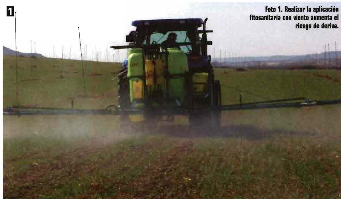
Foto 1. Realizar la aplicación fitosanitaria con viento aumenta el riesgo de deriva.
