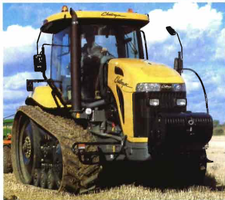
Las bandas de goma son semejantes a las cadenas pero de material elástico y de una sola pieza, lo que nos permite desplazarnos por la carretera.
