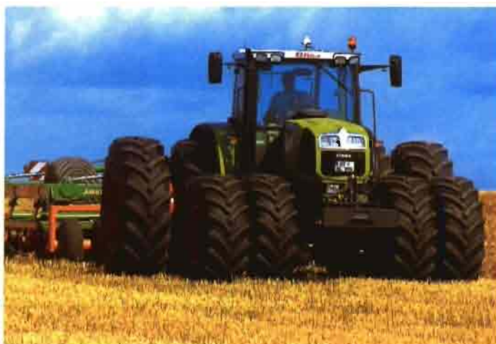
Otra forma de conseguir una mayor superficie de apoyo, y por tanto, una mayor tracción, es duplicar las ruedas.
