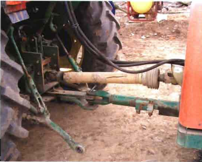
Foto 7. Transmisión de toma de fuerza defectuosa.
