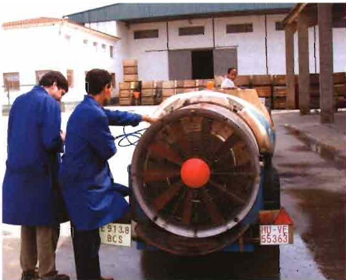
Foto 5. Cuantificación de la velocidad de aire a la salida del ventilador.
