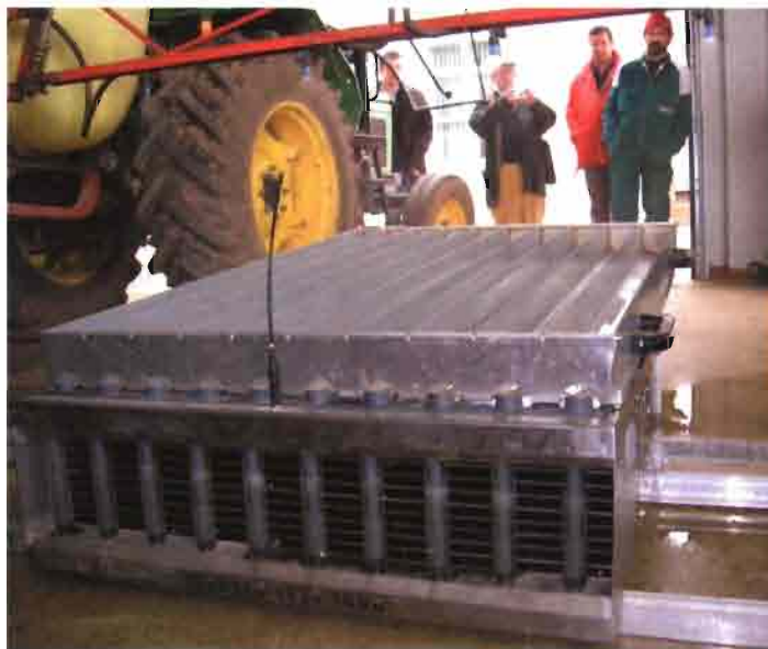
Foto 3. Equipo para la medida de la distribución de producto en pulverizadores de barra.
