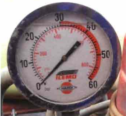
Foto 9. Manómetro de regulación de presión.
