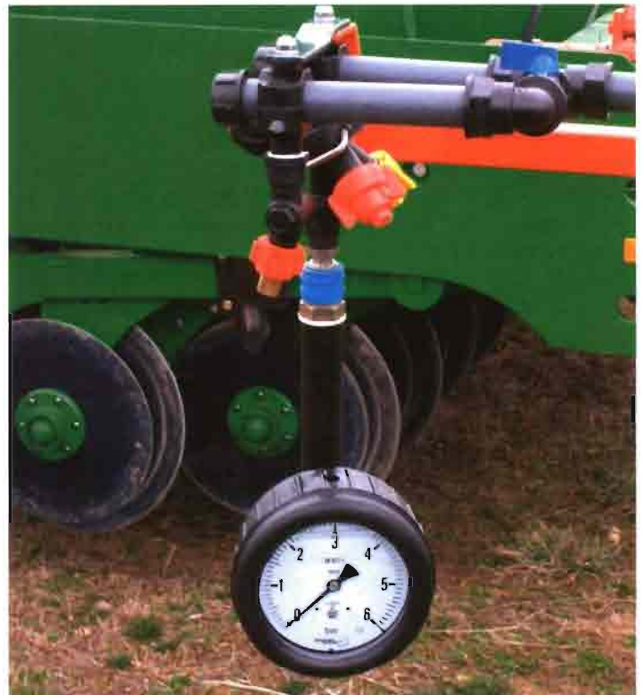
Foto 6. Medida de presión en el circuito hidráulico del pulverizador.
