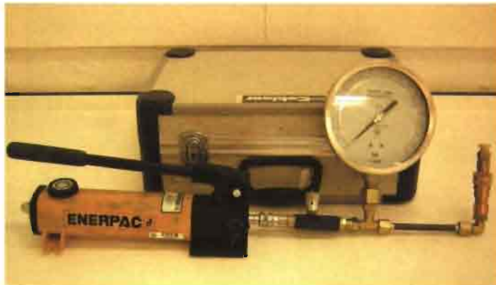
Foto 2. Manómetro de referencia para contraste de presiones.
