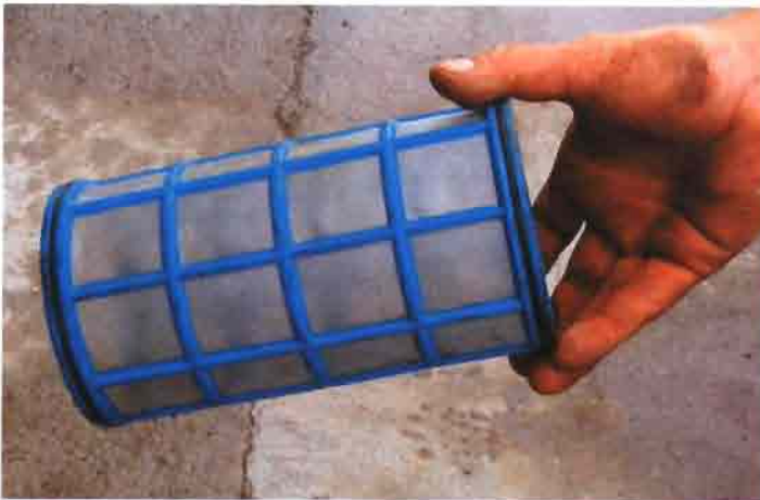
Foto 8. Detalle de filtro en buen estado.
