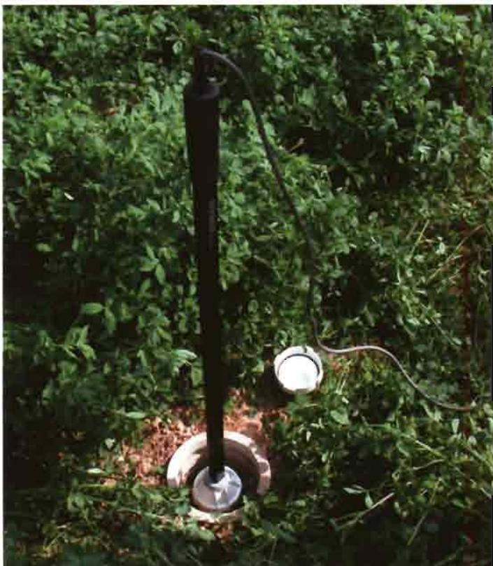
En la imagen inferior, sonda para la medida del contenido de humedad.
