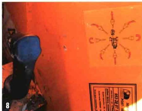
Foto 8. Palanca de desplazamiento y vibración y, a su derecha, pegatina explicativa.
