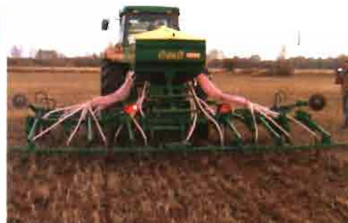
Sembradora a chorrillo Julio Gil con extracción de semillas por sistema neumático.
