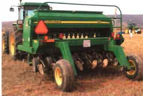
Sembradora John Deere modelo 1590, con extracción de semillas por sistema mecánico.
