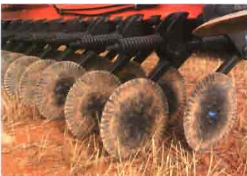
Diversos tipos de discos cortadores que cortan el rastrojo y abren una pequeña grieta en las líneas donde a continuación se depositarán las semillas.
