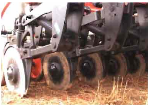
Diversos tipos de discos cortadores que cortan el rastrojo y abren una pequeña grieta en las líneas donde a continuación se depositarán las semillas.
