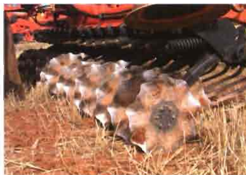
Diversos tipos de discos cortadores que cortan el rastrojo y abren una pequeña grieta en las líneas donde a continuación se depositarán las semillas.
