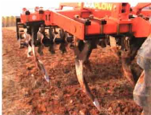
Apero combinado Razol modelo Araplow, constituido por reja esponjadora a profundidad seguida de discos ondulados y de rodillo jaula.
