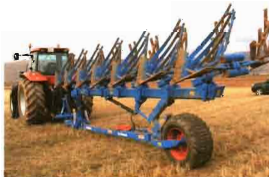
Arado reversible Lemken, modelo Vari Diamant, de vertederas partidas en posición de transporte.
