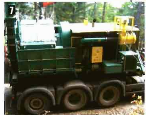
Fotos 2 y 3. Astilladora móvil que recoge residuos en la zona de trabajo.
