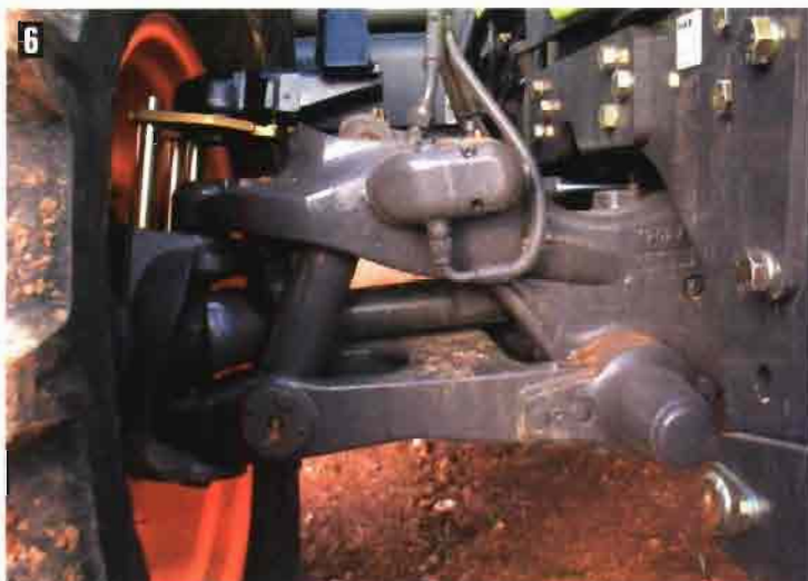
5 y 6. Detalle de dos posiciones del eje delantero con la suspensión Proactiv fijada en dos alturas diferentes.
