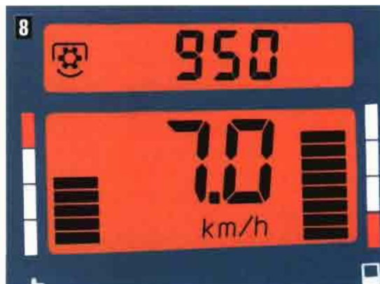
7 y 8. Pantalla situada en el lado derecho del salpicadero que informa de la velocidad de giro del motor y de la velocidad de giro de la toma de fuerza.
