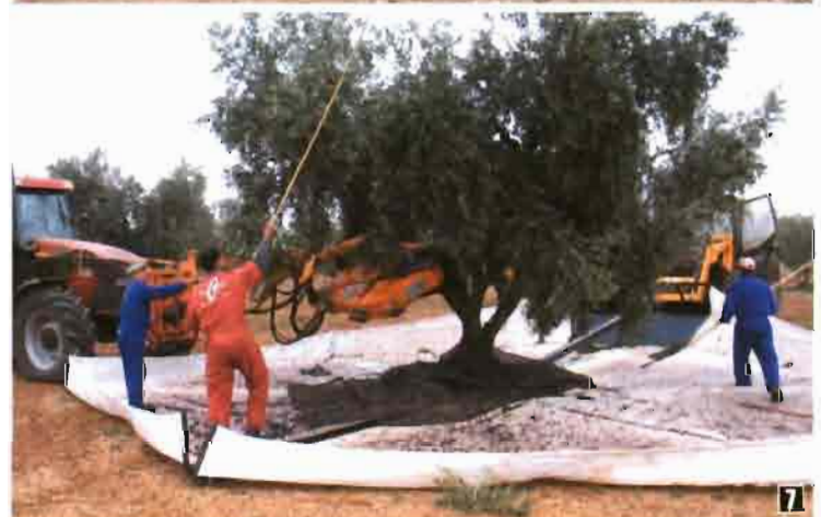
Foto 2. Vibrador de ramas accionado por el motor situado al inicio de la pértiga.
