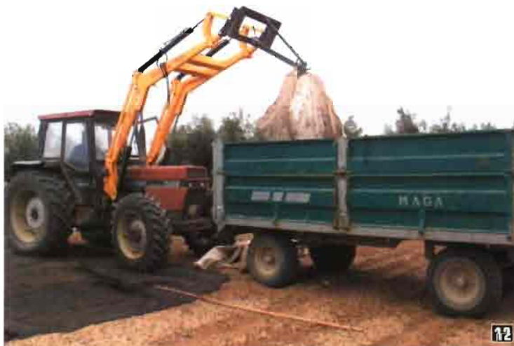
Foto 11. Recogiendo la mantilla con el gancho situado en el extremo de una pala cargadora.
