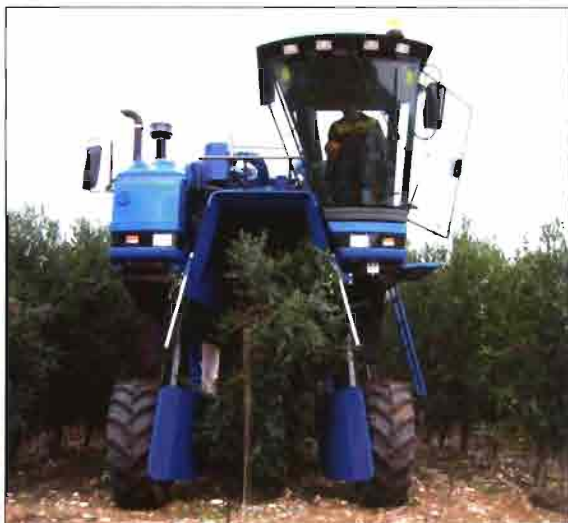
Foto 5. Máquina cosechadora cabalgante recolectando mecánicamente una plantación superintensiva de 3 años de edad, momento en el que el tamaño de los árboles permite una alta eficiencia de este tipo de maquinaria. A la derecha vista del interior de la máquina cosechadora en la que se observa el trabajo de los batidores en operación de derribo de los frutos.
