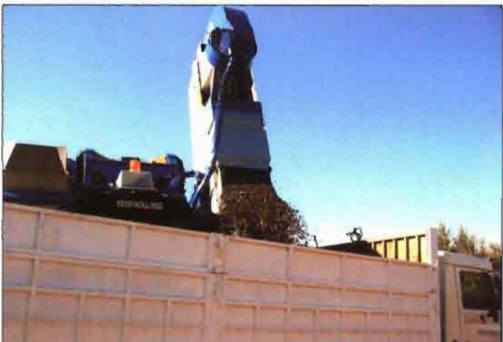
Foto 6. Detalle de mecanismo de interceptación de frutos derribados por los batidores (bandejas a modo de escamas) que posteriormente se transforman en cinta transportadora que conduce la aceituna a las tolvas de almacenamiento internas de la máquina cosechadora. Una vez llenas las tolvas, la aceituna es descargada en un camión para su transporte a la almazara.
