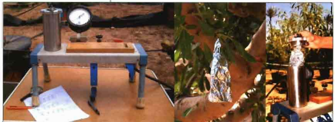
Foto 1. Cámara de presión y secuencia del proceso de medida del potencial hídrico de hoja cubierta.
