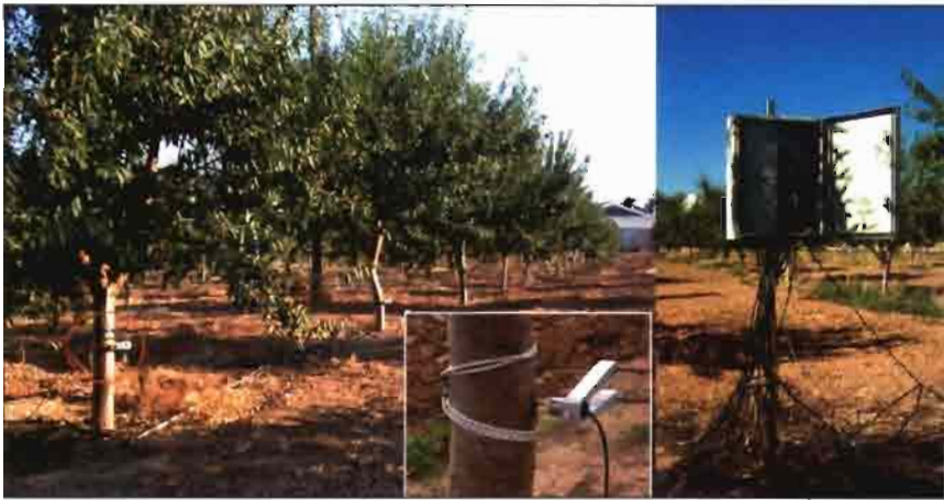
Foto 2. Parcela experimental de almendros 'Marta' (ETSIA-UPCT). Detalle de colocación de los sensores LVDT en tronco y equipo de almacenamiento de datos para el control del riego.
