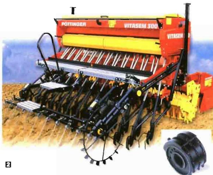
sa Pöttinger ha diseñado un enganche a los tres puntos con control pendular.
