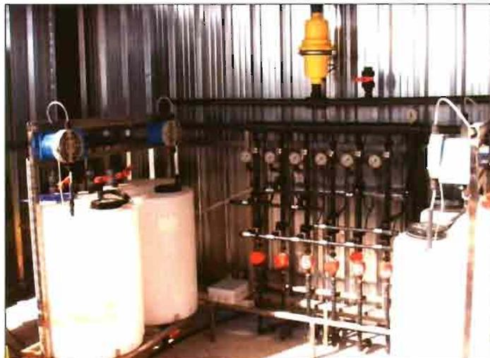
Cabeza del riego móvil con depósitos de soluciones concentradas, inyectores eléctricos y agitador mediante bomba soplante.
