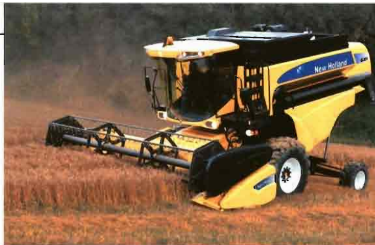
Novedad destacada es la New Holland CL560, con una asombrosa capacidad para neutralizar desniveles de hasta el 38%.
