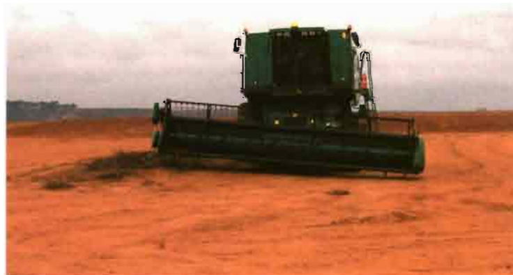
Con el sistema HillMaster II de John Deere resulta posible cosechar en desniveles de hasta el 22% sin merma de rendimiento.
