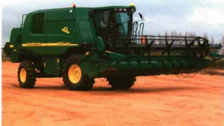
Con el sistema AutoTrac de John Deere sólo es necesario dirigir la máquina durante las maniobras de cambio de dirección y para salvar obstáculos.
