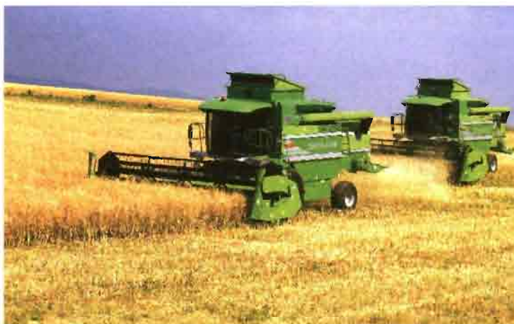
En las cosechadoras de la serie 56 se instalan motores Deutz de 240 CV refrigerados por aire y de 320 CV refrigerados por agua
