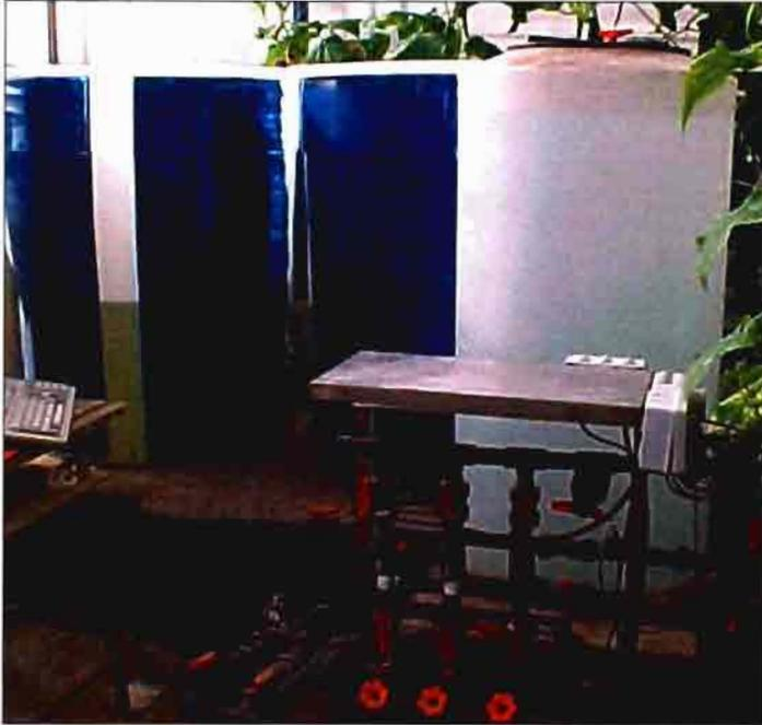
Foto 3. Detalle de un sistema de fertirriego sencillo con dos tanques para soluciones madres a concentraciones fijas y un tercero para el ácido, con venturis e inyección directa a la red.
