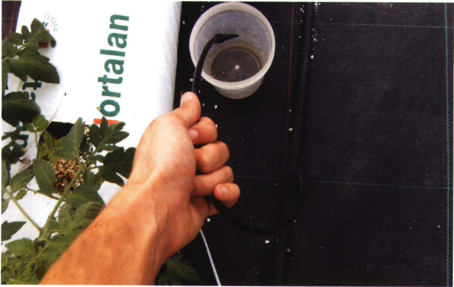
Foto 1. Medición de caudal en un emisor autocompensante en cultivo sin suelo
