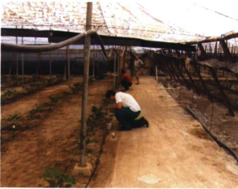
Fotos 2 y 3. Medición de caudales a lo largo de un ramal de riego
