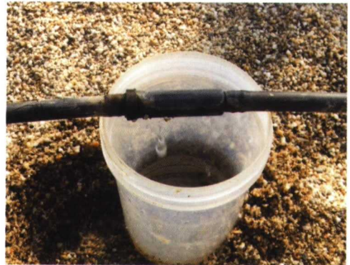
Fotos 2 y 3. Medición de caudales a lo largo de un ramal de riego
