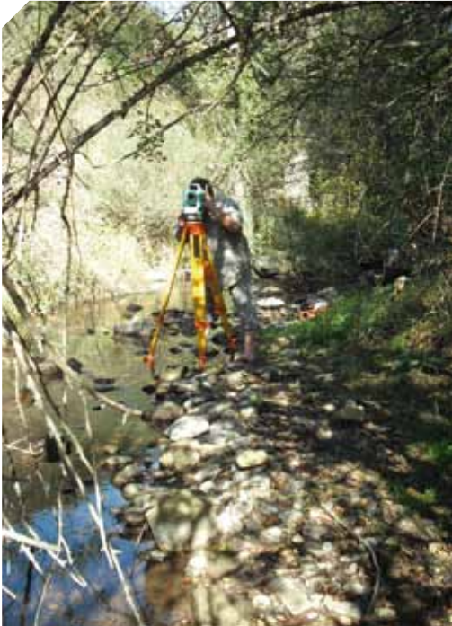
Realización de perfiles transversales utilizando la estación total de topografía
