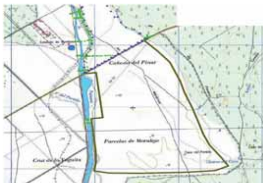
Figura 9. izquierda: Superficie de inundación-laminación-sedimentación (227 ha.) ubicada aguas abajo del umbral de vertido del camino asfaltado entre El Rocío y Villamanrique de la Condesa, en el tramo comprendido entre el puente sobre el arroyo del Partido hasta el puente sobre el arroyo de la Cañada del Pinar. Derecha: Camino asfaltado entre El Rocío y Villamanrique de la Condesa en el tramo mencionado, que puede convertirse en umbral de vertido del volumen de agua almacenado aguas arriba del mismo.
