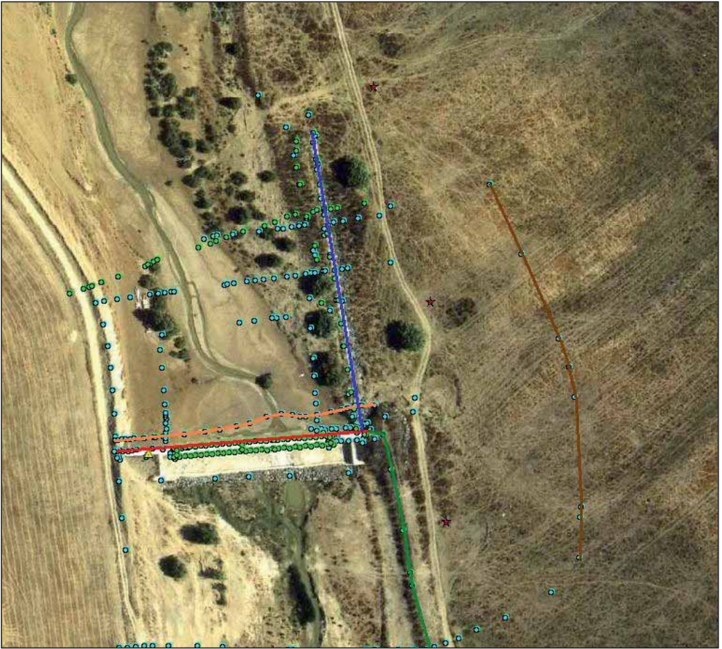
Figura 4. Vista en planta del DIQUE 1 sobre una fotografía aérea de agosto de 2008 en la que aparecen: a) puntos del terreno obtenidos con levantamientos topográficos utilizando una estación total (azules) en 2007 y un DGPS (verdes) en 2008; b) la línea roja que define la posición del vertedero frontal; c) la línea azul que establece el vertedero lateral; d) la curva marrón que representa el perfil del terreno en el área de inundación-sedimentación, inmediatamente aguas abajo del vertedero lateral; e) la línea naranja que define un perfil levantado al cauce aguas arriba del dique; f) la línea en verde oscuro que representa a la nueva mota construida en el margen izquierdo del arroyo del Partido, aguas abajo del dique, para separar la superficie de inundación-sedimentación de la del cauce del arroyo.
