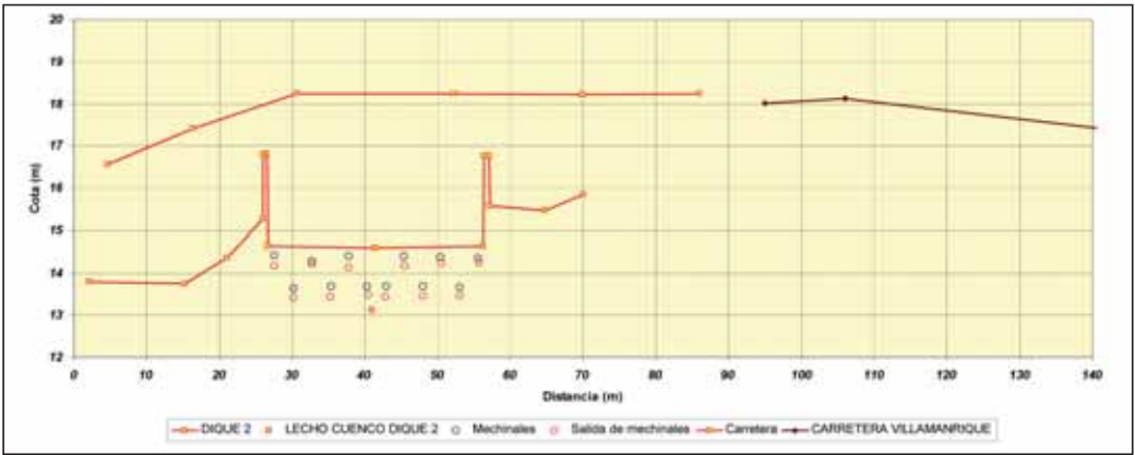
Figura 6. Alzado del DIQUE 2 in front elevation seen from downstream (in red). También se representan: a) el lecho del arroyo (cuadrado amarillo); b) el puente sobre el arroyo (en rojo); c) el camino asfaltado (en marrón). En relación con los mechinales: los círculos azules corresponden a entradas de flujo y los círculos rojos a las salidas.
