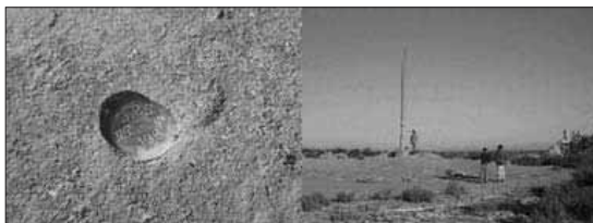
Figura 4. Placa de bronce con las iniciales J. P. S.-N. T. 106, empotrado en el basamento de una antigua baliza del río Guadalquivir, próxima a la casa de la salina de San Isidoro, tiene de cota 4,018 m respecto del nivel del mar en Alicante y se utilizó como punto de partida para dotar de altimetría a toda la marisma.
