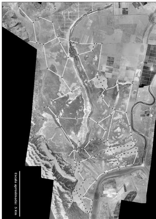
Figura 2. Estado final de las operaciones topográficas de nivelación geométrica realizadas en la marisma del PND entre 1995-99. En verde, las operaciones con precisión realizadas en los lucios y en las secciones transversales de los caños; en amarillo, las nivelaciones de unión. Los puntos azules representan los hito-fenos o puntos de cota conocida.
