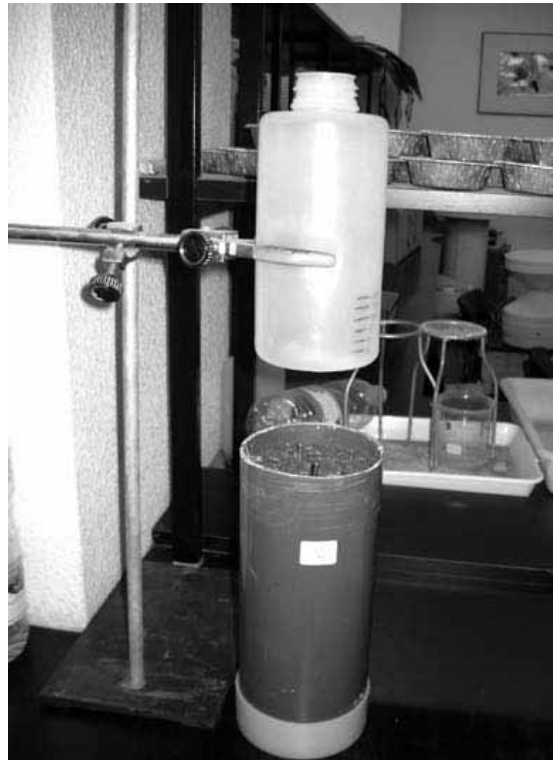
Figura 2. Cilindro de suelo sin alterar para la obtención de las ecuaciones de conversión humedad - precipitación.
