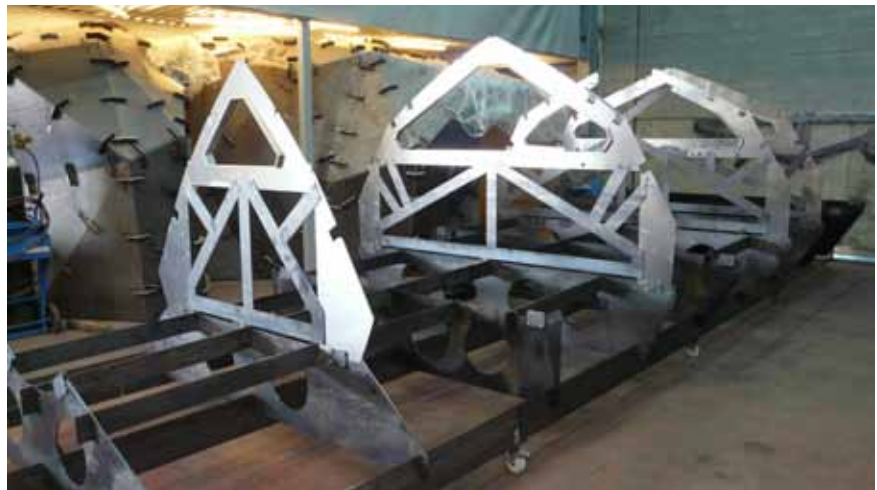
Estructura inicial de una embarcación de aluminio.
