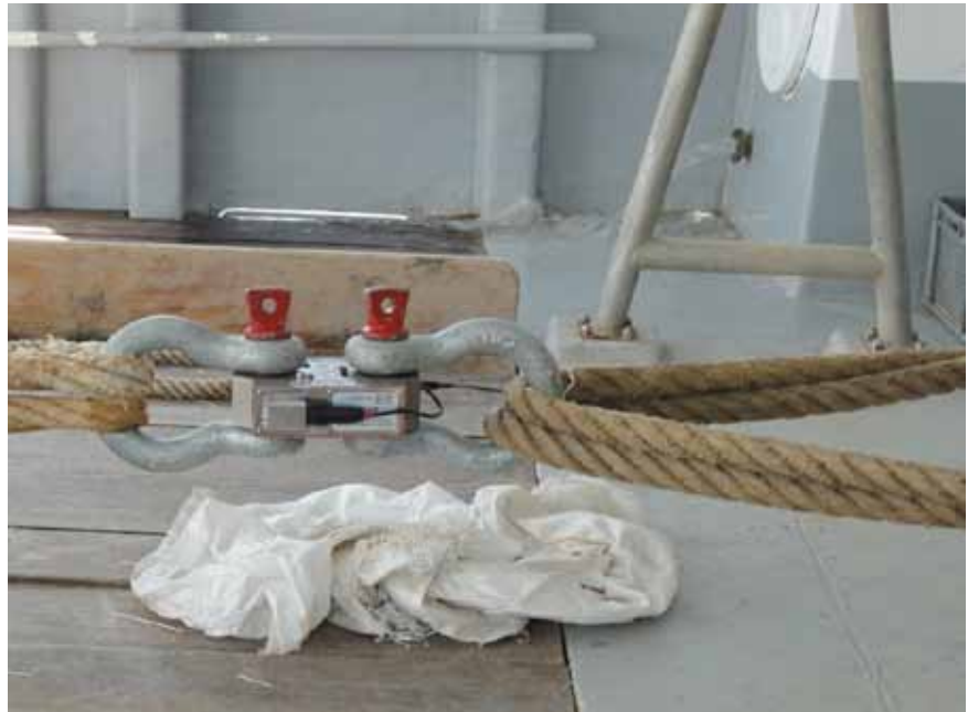
Prueba de tiro a bordo con dinamómetro electrónico de tracción.
