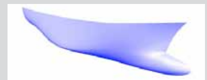
Representación de un diseño de bulbo de proa.
