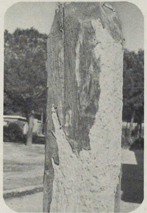
Ataque de lictidos ( polilla ) en una estaca de eucalipto.
