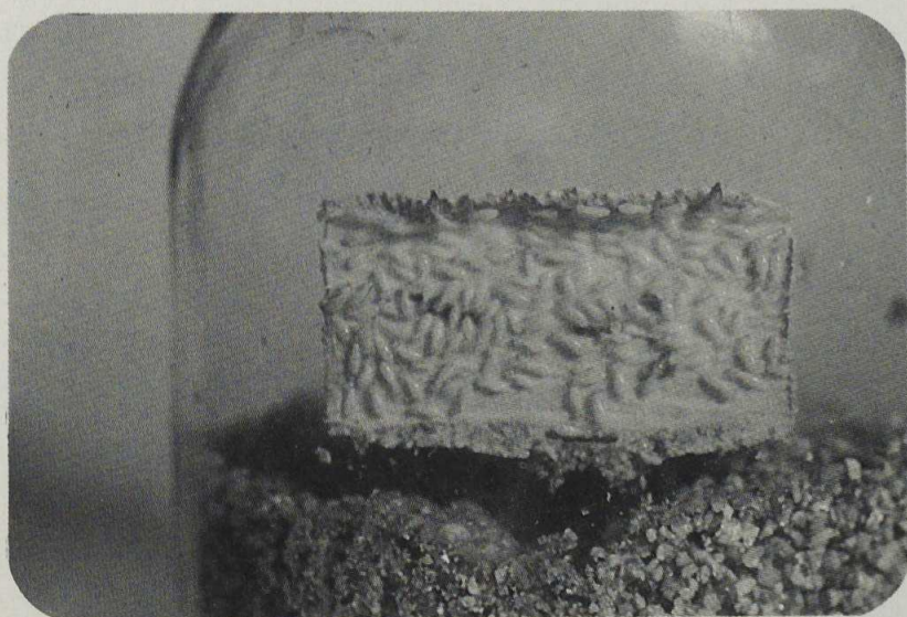
Colonia de termes en un ensayo de eficacia de protectores.
