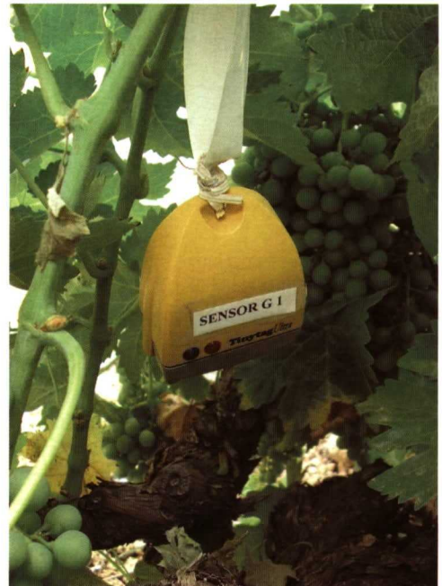
Figura 3. Sensor Tinytag Ultra colocado en el interior de la cepa.
