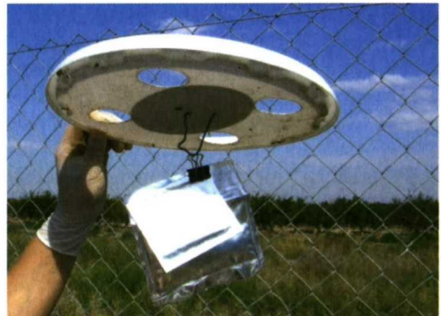
Figura 2b. Difusor de feromona y difusor de acetato de etilo que se colocan colgados de la tapa.
