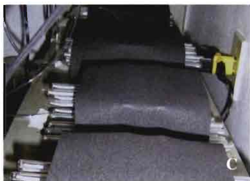
Figura 1. A) Visão interna da mini-câmara de exaustão; B) Ponteiras acopladas às células da placa ELISA®, e tubos de Duran acoplados às ponteiras; C) Visão lateral do conjunto de mini-câmaras (borracha de EVA preta); D) Aeração - visão das mini-câmaras (abaixo) acopladas aos compressores de ar (acima) por pequenas mangueiras de borracha.
