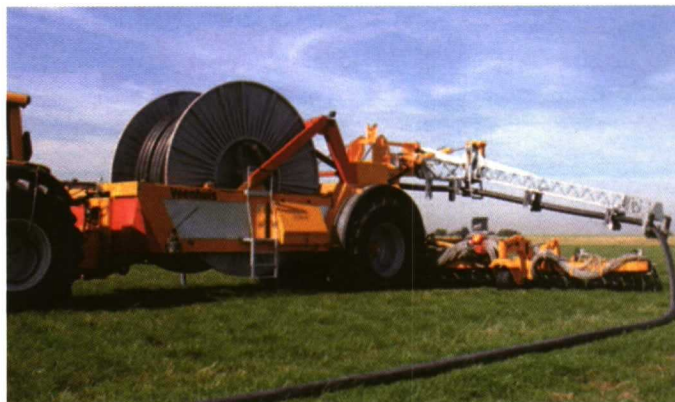
Un nuevo concepto de gran interés es la inyección con manguera remolcada, en la que la máquina distribuidora carece de cuba y está unida permanentemente a un depósito lejano mediante una gran manguera.
