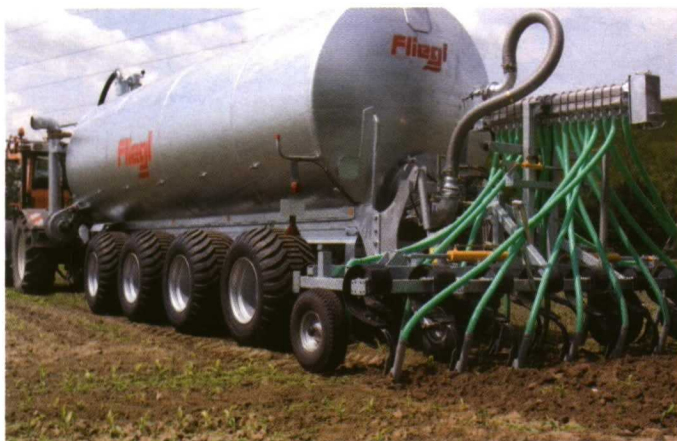
Cisterna distribuidora de cuatro ejes, con inyección localizada mediante rejillas abresurco.
