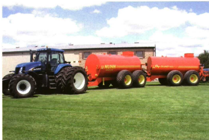
Las grandes explotaciones tienden a adquirir sistemas de hasta cuatro ejes con chasis articulado.
