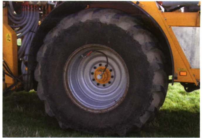
Los sistemas de inflado automático de las ruedas de los grandes remolques distribuidores son imprescindibles para disminuir automáticamente la presión y reducir la compactación.
