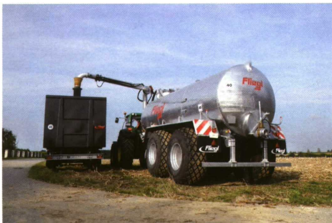
Las nuevas tendencias apuntan a la separación entre transporte y distribución, empleando camiones o depósitos en el lateral de la parcela.
