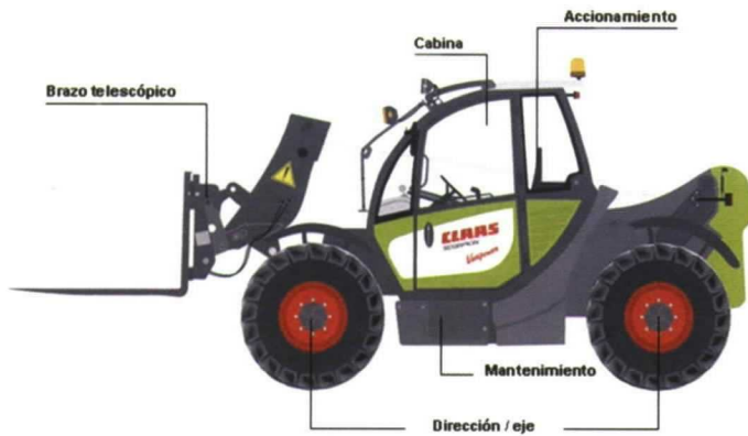
Figura 1. Esquema de una cargadora telescópica. Fuente. www.claas.es
