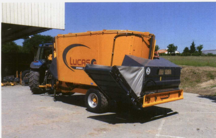
Foto 3. Carro mezclador arrastrado por tractor.
