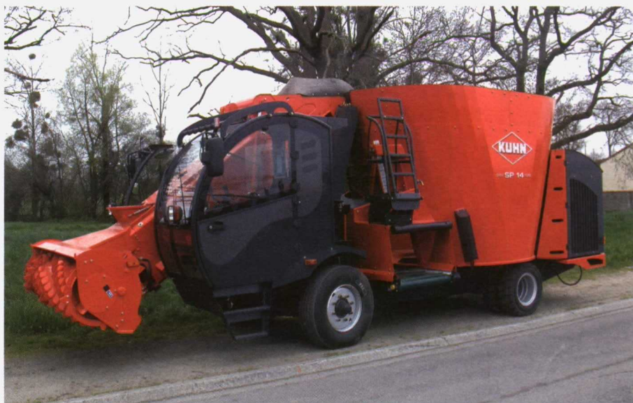
Foto 1. Mezclador autopropulsado. Detalle de la fresa delantera.
