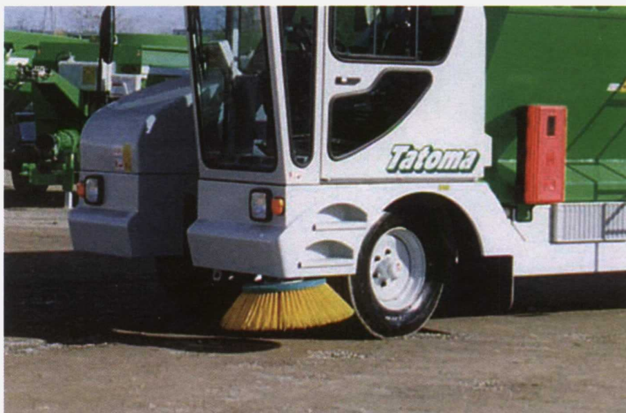
Foto 2. Cepillo barredor que puede instalarse delante de las ruedas.
