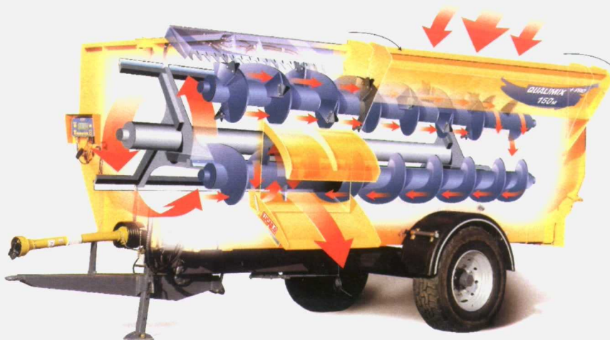
Foto 5. Sistema de trabajo de un carro horizontal.
