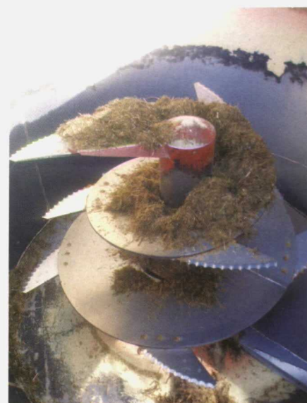
Foto 6. Interior de un carro mezclador con un rotor vertical.
