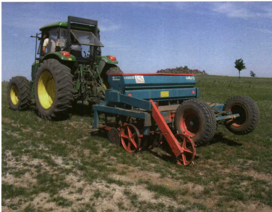
Foto 7. Máquina para praderas deterioradas arrastrada con enganche trasero, con disco de apertura del terreno y bota de siembra inmediata, detrás lleva un disco apelmazador. La semilla se porta en una tolva superior y cae por gravedad distribuida por un eje dentado a través unas trampillas.
