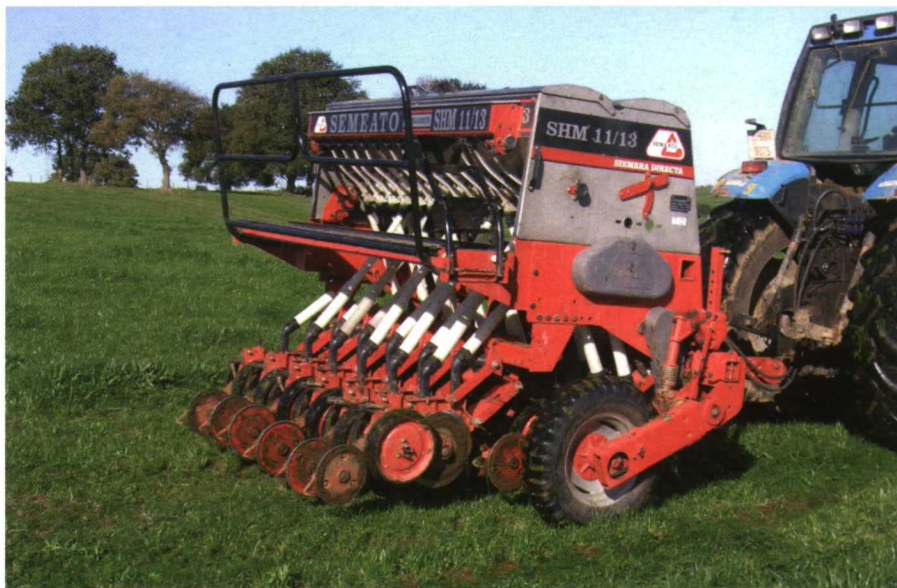
Foto 4. Máquina para siembra y resiembra directa con tolvas independientes para leguminosas y gramíneas, con dos discos de corte y rodillos de goma para el cerrado del surco. Autor. J. Valladares.
