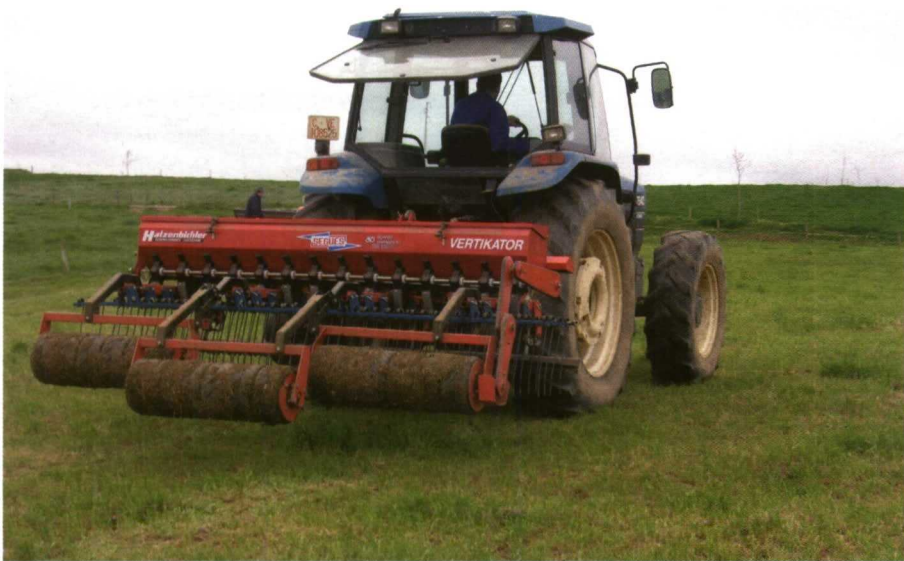
Foto 3. Máquina versátil ligera para siembra y resiembra de praderas, con tolva única y distribución por ventana de alimentación, con cinco líneas de púas y compactación por rodillos de goma, como opción puede llevar barra niveladora del terreno. Autor. J. Valladares.
