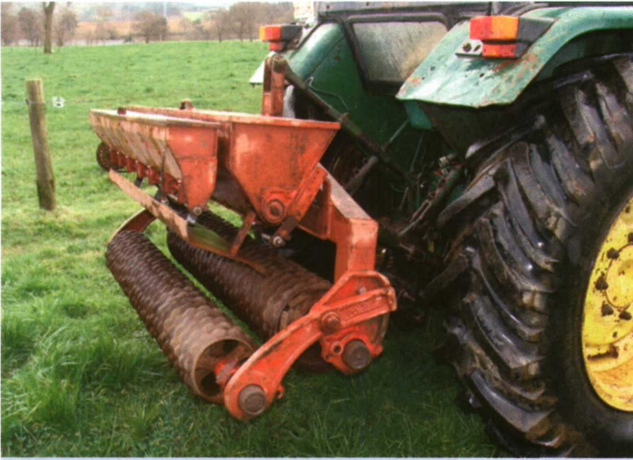
Foto 2. Máquina sembradora de pratenses con rodillos dentados y tolvas independientes para gramíneas y leguminosas con distribución por ventanas de alimentación. Autor. J. Valladares.
