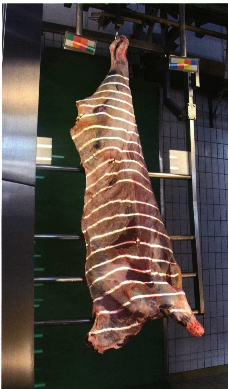
Figura 4. Máquina de clasificación objetiva de canales (BCC-2), desarrollada por DMRI en 1996.
